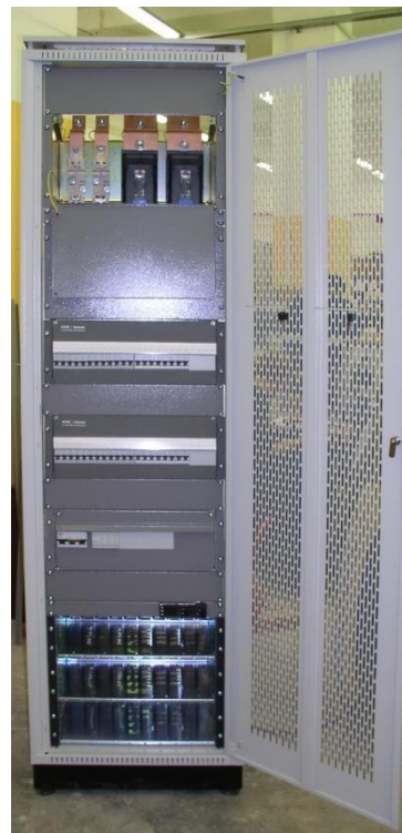
Модульная ЭПУ серии ЭС-48/1125-42U с двумя модулями распределения ВРМ-24, в модуле подключения АКБ установлены два держателя NH2 (до 400А) для подключения нагрузок
